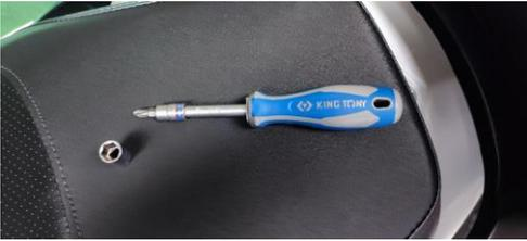
Pour changer le compteur vous aurez besoin d'un tournevis cruciforme et d'une douille de 10mm
