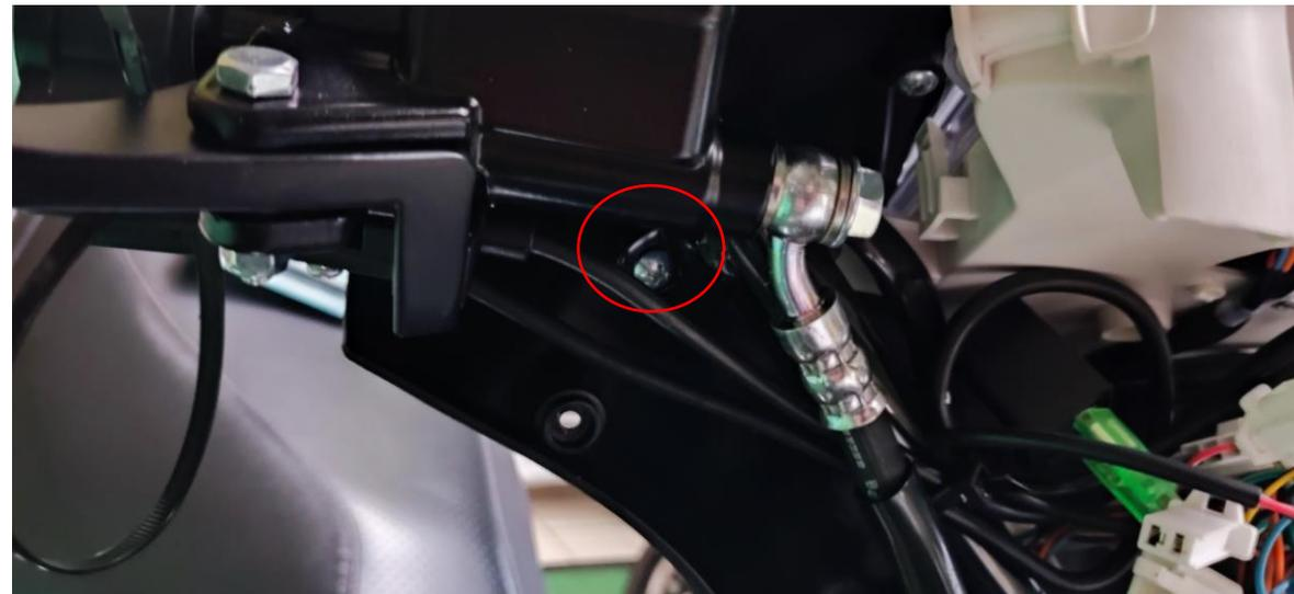
Une fois la partie avant déboîtée retirer 2 autres vis pour démonter la partie qui supporte le compteur
